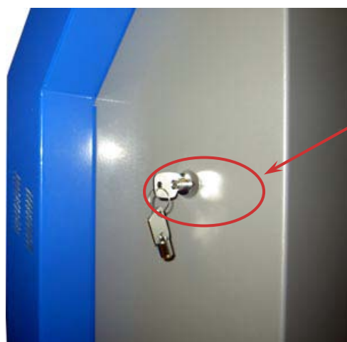
Рис. 18. Включение компьютера ключом электромеханического замка
