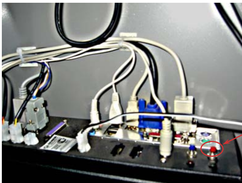
Рис. 17. Нажать кнопку включения компьютера
