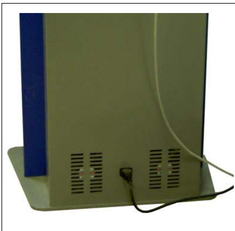
Рис. 12. Разъем питания автомата
