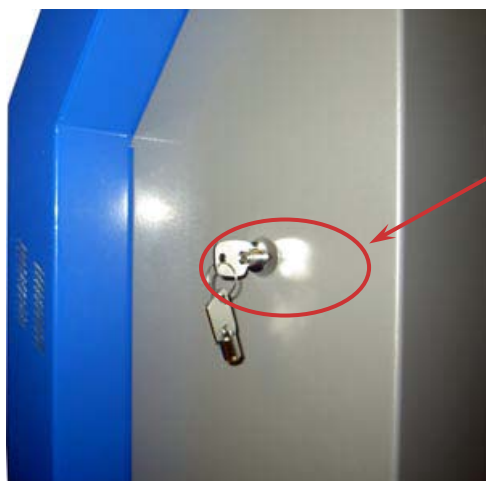
Рис. 18. Включение компьютера ключом электромеханического замка
